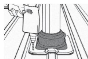
5. Fixer le Dekтите® avec les vis auto-perceuses EJOT® ou les rivets "Bulb-tite"
